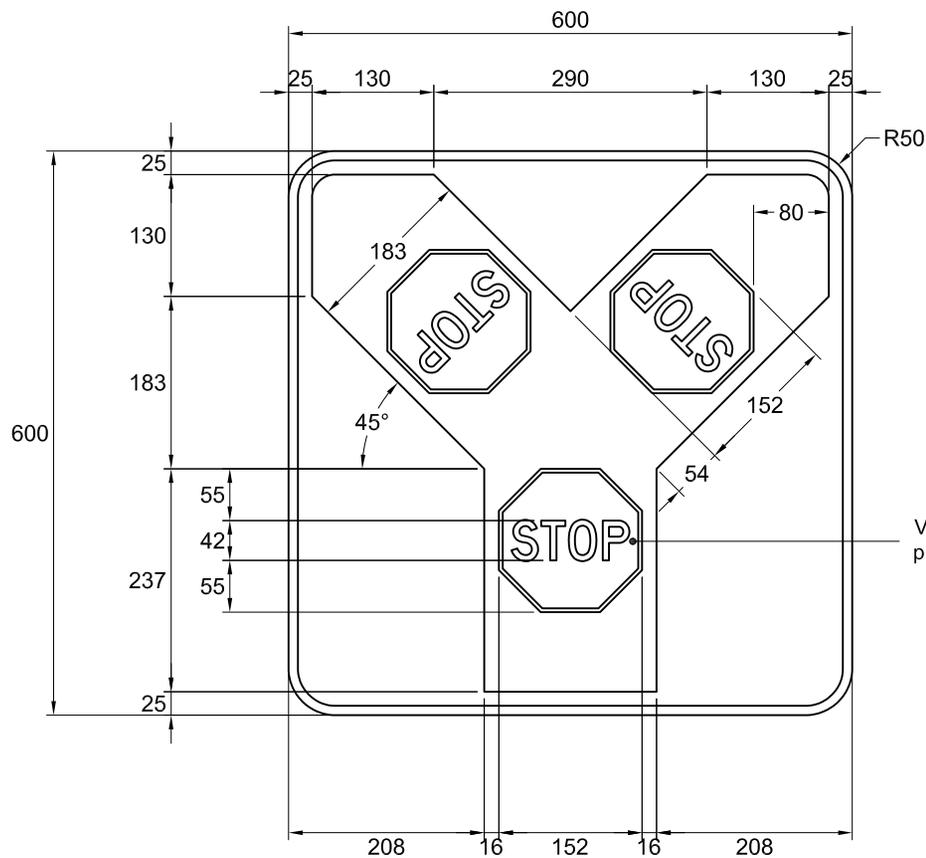
Voir devis du panneau P-10 et ajuster proportionnellement les dimensions
