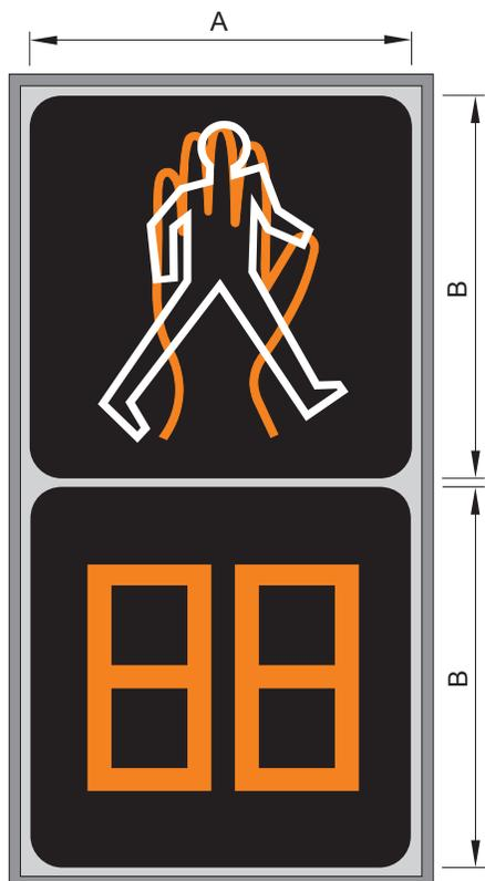
**Dimensions minimales des éléments des lanternes (mm)**
