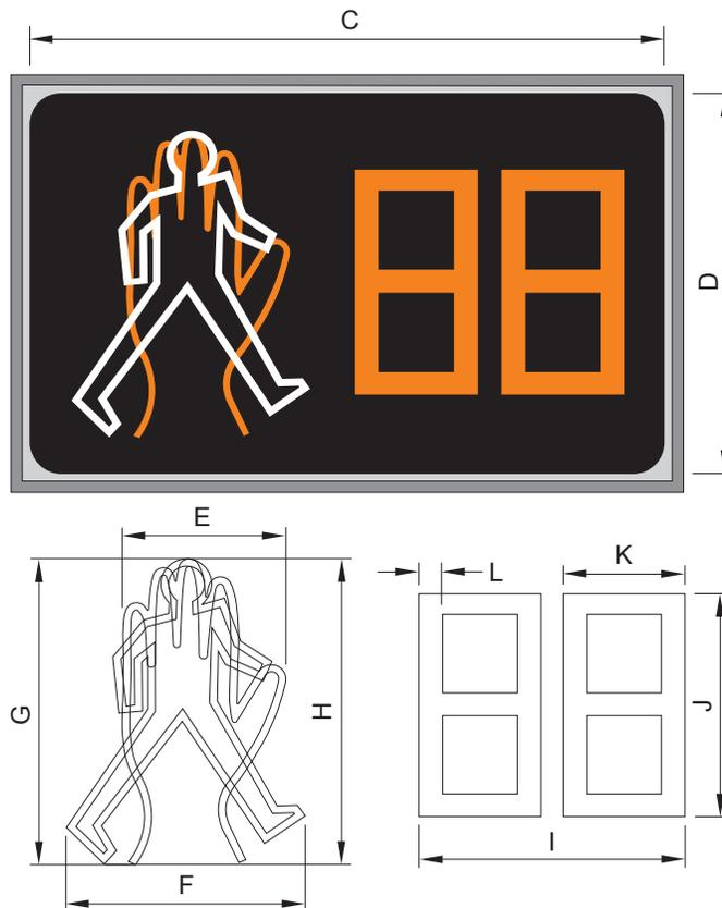
**Dimensions minimales des éléments des lanternes (mm)**
